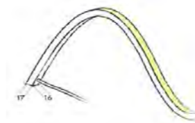
L 16 x H 17mm Ø min di piegatura 300mm/ min bending Ø 300mm
